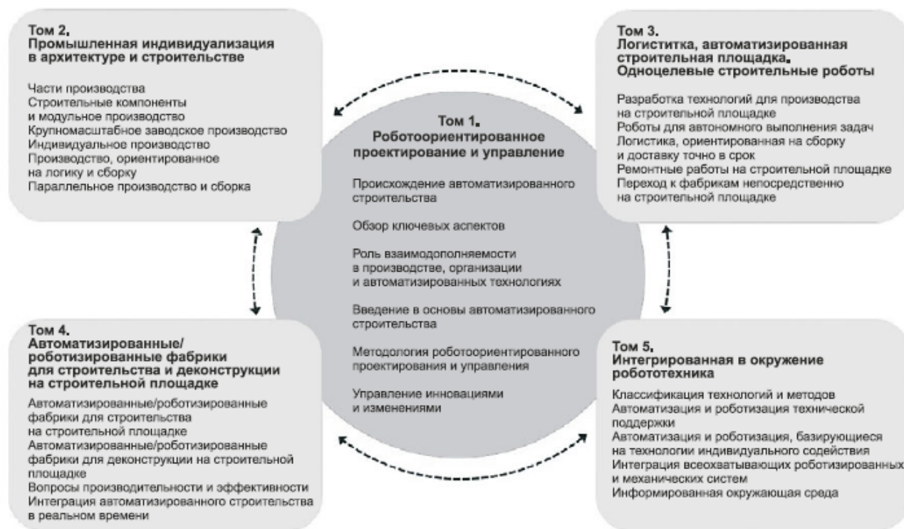
Рис. 2. Концептуальный подход для применения робототехники на строительном производстве
